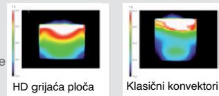
Difuzija topline HD grijaćih ploča u usporedbi s klasičnim konvektorom
